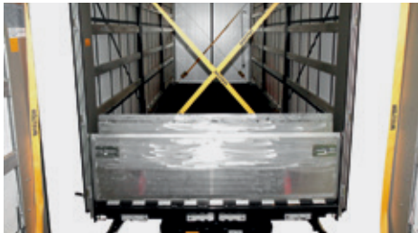
A karosszéria elemek könnyű és tartós kompozit anyagokból készülnek, melyek megfelelnek az ECE szabvány előírásainak.
